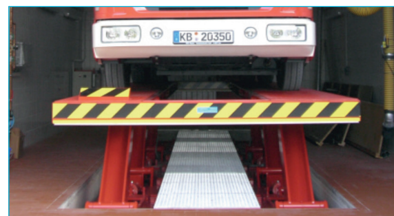
STARR E 20 MHR als Waschbühne bodeneben eingebaut
