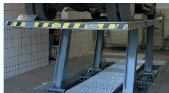
STARR E 5 MHR als Waschbühne bodeneben eingebaut
