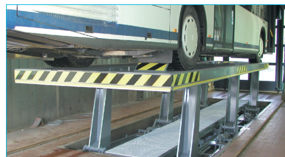
STARR E 15 MHR als Waschbühne bodeneben eingebaut
