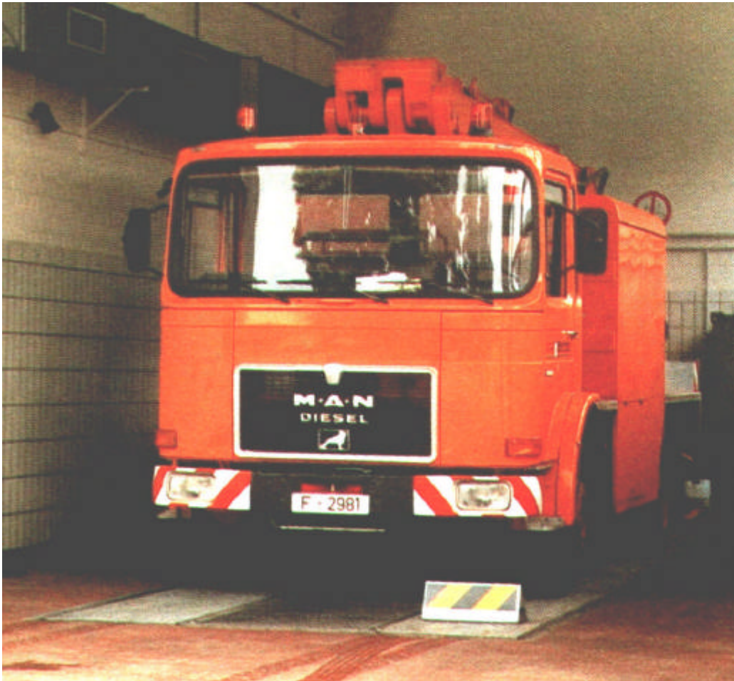
STARR E 20 MHR als Waschbühne bodeneben eingebaut
